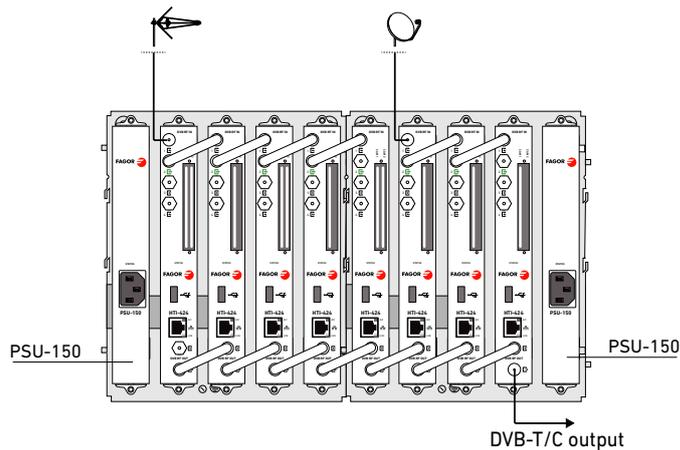
Exemple d'installation contenant 8 transmodulateurs HTI + 2 sources d'alimentation PSU-150, montés sur 2 platines BACK-500 connectées par le pont USB.
